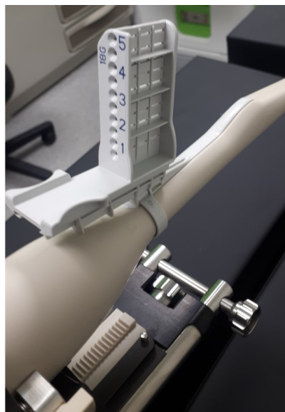
Εικόνα 21: EV29L με τοποθετημένο τον αποστειρωμένο διαπερινεϊκό οδηγό βελόνας EV29L (εμφανίζεται χωρίς θηκάρι)
