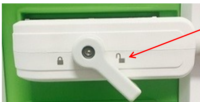
Εικόνα 29: Ξεκλειδωτός επιλογέας ασφάλισης συνδέσμου ηχοβολέα
